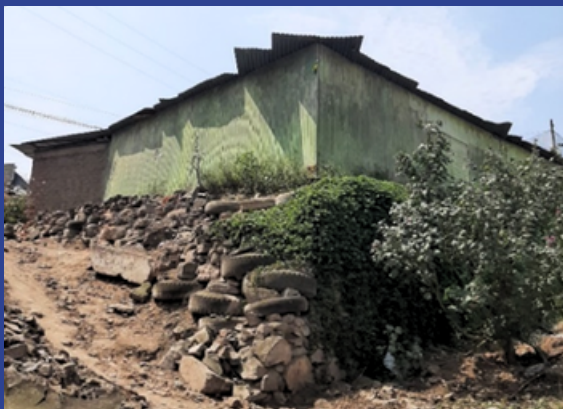
Fig. 2 Vivienda cuyo desnivel ha sido colmado de piedras y llantas para "nivelarlo".
