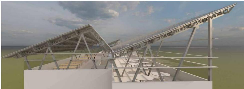
**Proyecto Facultad de Arquitectura y Urbanismo con cobertura de paneles solares:** consiste en la colocación de una cobertura de 398 paneles solares aproximadamente, elaborada sobre un sistema estructurado en acero en el último nivel (primer prototipo), el cual servirá para captar energía solar para uso de la facultad, así como crear un espacio dirigido a los estudiantes con zonas de trabajo además de un área diferenciada para consumo de alimentos y de descanso.
