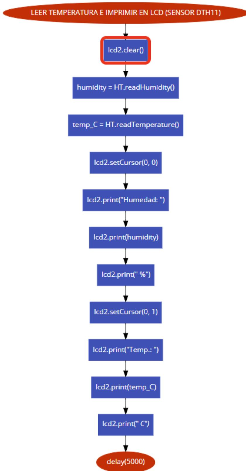
Fig. 4. Diagrama de flujo para detectar la humedad y temperatura del sensor DTH11.
