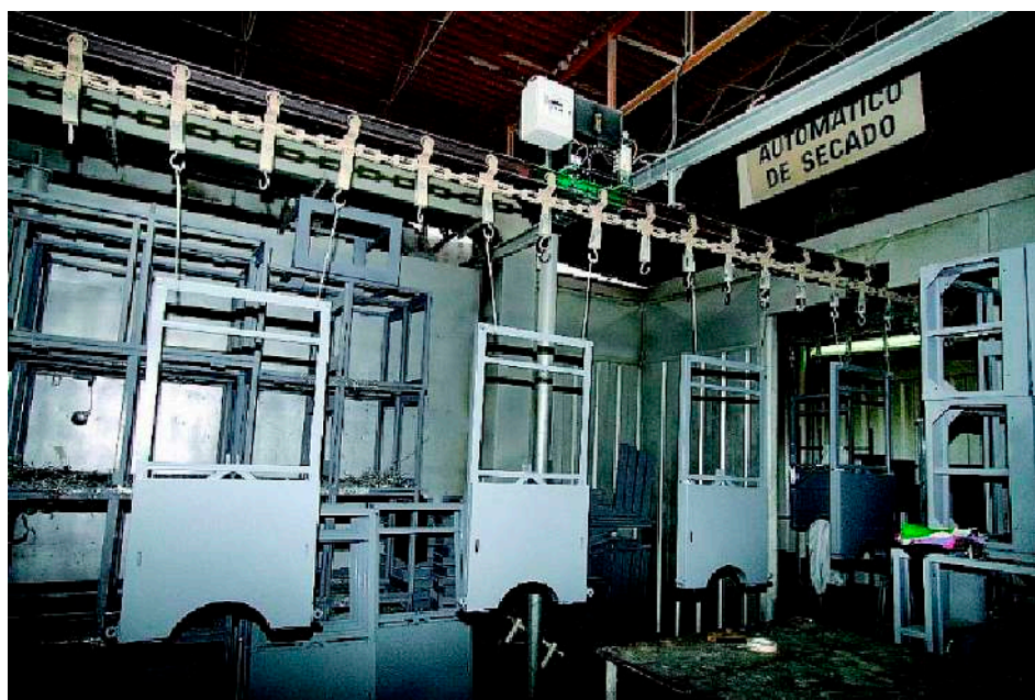
Figura 34. Horno de secado de baja eficiencia
